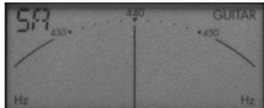
FIGURE 1 – Accordeur électronique. Lorsque l'aiguille est au milieu du cadran, le son est à 440 Hz et l'instrument est accordé.
