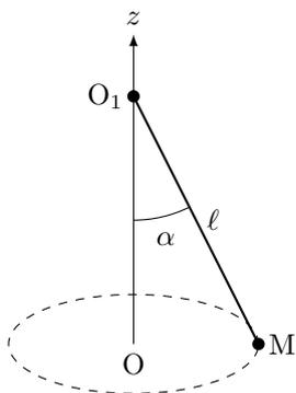
Un enfant fait tourner un pendule constitué d'une ficelle de longueur  $\ell$  fixée en  $O_1$  et d'un caillou de masse  $m$  de telle façon à ce que le caillou effectue un mouvement circulaire uniforme dans un plan (l'angle  $\alpha$  reste constant par rapport à la verticale).
