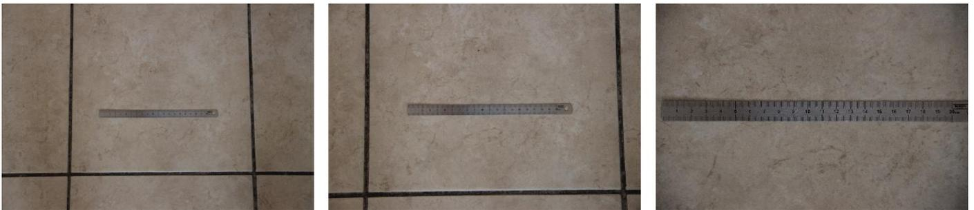
Photographies d'une règle de 20 cm. Entre chaque photographie, seule la focale a été modifiée. Le capteur CCD est de dimension 14,9 mm  $\times$  22,3 mm et les photographies ont été prises à environ 1,7 m de distance.
