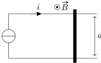
On utilise un aimant en U pour créer un champ magnétique uniforme sur une assez grande partie du barreau mobile.
